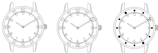
图 7.2 设定计时起点示意图 10:10 出发去往公交站, 将计时起点对准分针
